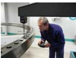
Mit dem speziell für Großwälzlager angefertigten Messgerät werden die Durchmesser, Längen, Bohrbilder und Verzahnungen vermessen
