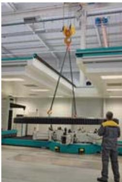
Wenn das Großwälzlager im Messraum ist, kann das Tor wieder geschlossen werden. Für das Positionieren auf der Messmaschine muss nur das Dach offen bleiben. Die Störung der Klimatisierung reduziert sich dadurch auf ein Minimum (links)
