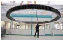
Bei der Auslegung der Klimakomponenten wurde berücksichtigt, dass die Großwälzlager bis zu 20 Tonnen wiegen können und mit Hallentemperatur in den Messraum eingebracht werden
