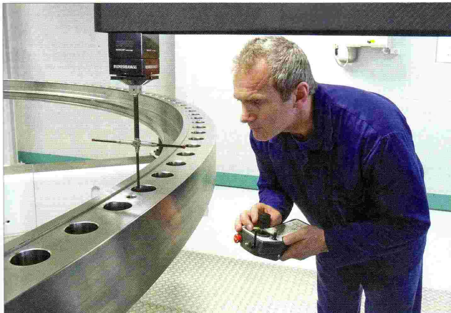
2: Damit das Gerät zur Vermessung der Großwälzlager stets exakte Ergebnisse liefert, müssen konstante klimatische Bedingungen im Messraum gewährleistet sein.
