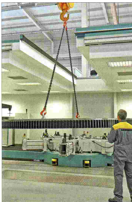
3: Ist das Lager im Messraum angekommen, wird das Tor geschlossen – die Störung der Klimatisierung ist so auf ein Minimum reduziert.
