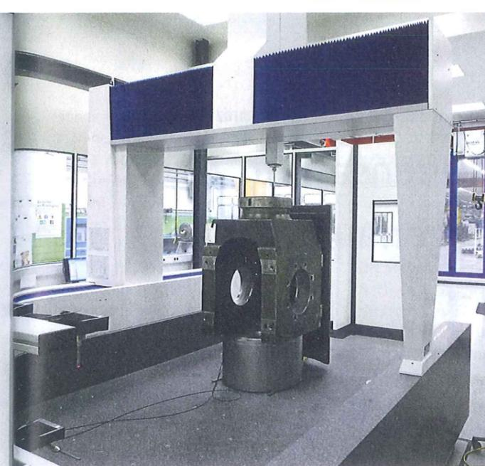
*Dimensions- sowie Form- und Lageprüfung eines rund 60 Jahre alten Kreuzkopfes mit einem Außendurchmesser von 1000 mm auf der neuen Messmaschine von Carl Zeiss*
